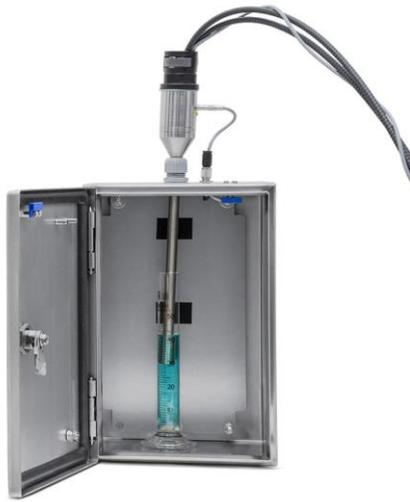
[安装于探头测量箱中的拉曼探头]
